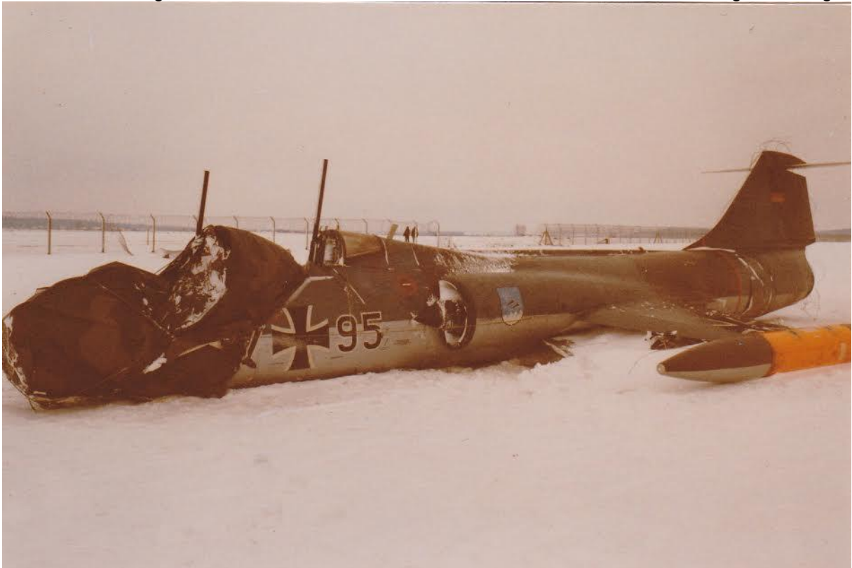
Die beiden Kabinen sind abgedeckt um die Instrumente für eine eventuelle Wiederverwertung zu sichern. Im Hintergrund sieht man den beschädigten Fliegerhorst Zaun
